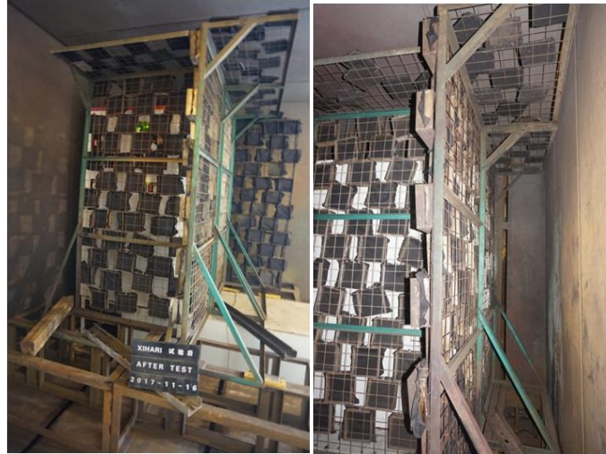
图 2 内部电弧试验的试验布置
