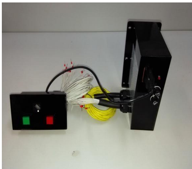
图 7-6 改进后分合闸按钮、转换开关
